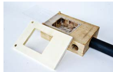
Obdelovanec je zavzel obliko kalupa
