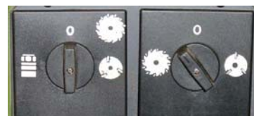
Kombinirani stroj za les bo deloval le, če sta vključeni obe stikali.
