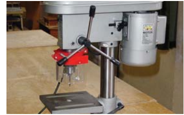
Elektromotor poganja vrtni stroj
