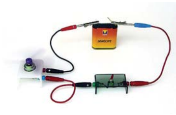
Vezava elektromotorja z baterijo prek enopolnega stikala
