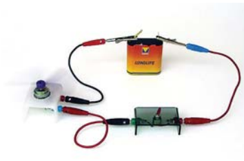
Zamenjava priključkov baterije spremeni smer vrtenja elektromotorja
