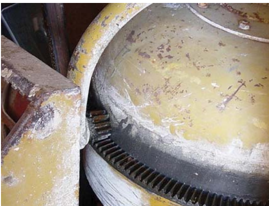
Zobniški par, s katerim zmanjšamo število vrtljajev pri mešalcu betona
