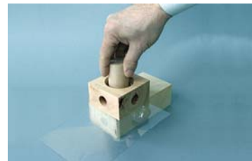
Vlečenje folije z vtiskanjem vlečnika
